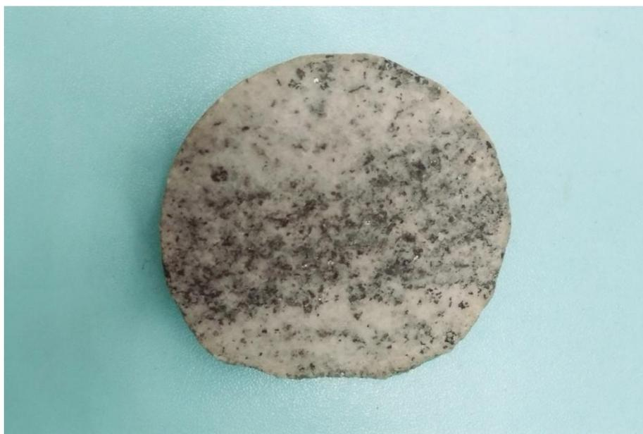
Рисунок – Срез керна из диорита, диаметр 5,5 см, вес 57,32 г, глубина 12 066 м (фото А. А. Богдасарова)
